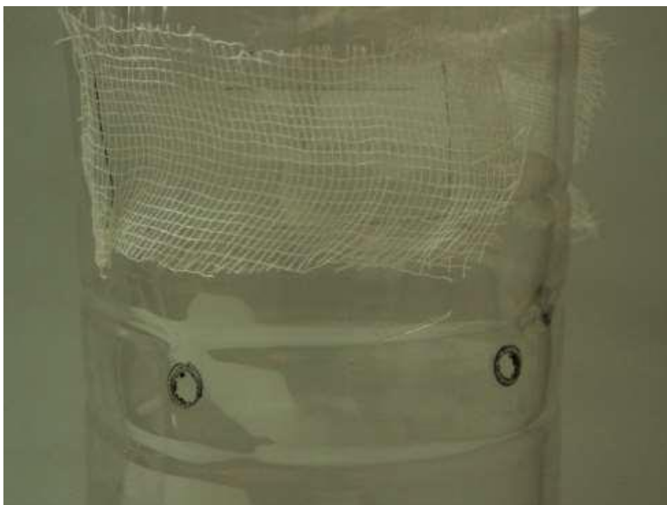
SLIKA 12. DEO KLOPKE SA OTVORIMA ZA ŠIRENJE MIRISA I ZA ULAZ MUŠICA
