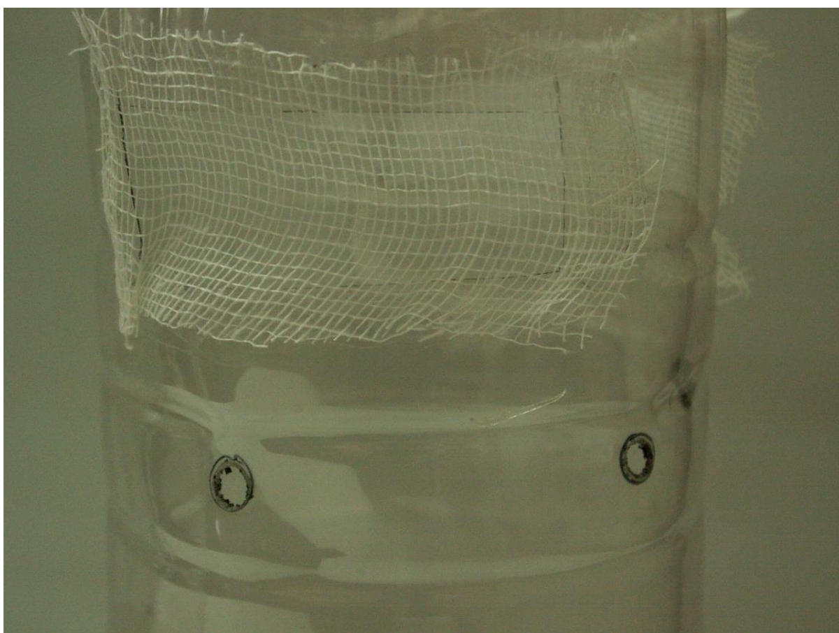
SLIKA 6. DEO KLOPKA ZA AZIJSKU VOĆNU MUŠICU
